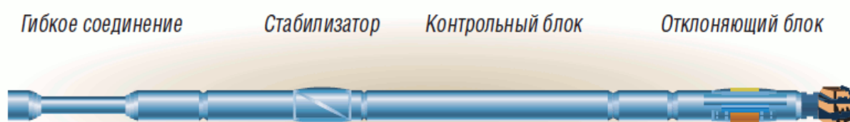
Рисунок 2. Основные элементы роторно-управляемой системы.
