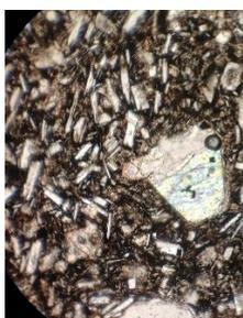
**Рисунок 13.** Шлиф, сделанный из материала бусины черного цвета. Слева проходящий свет, справа – скрещенные николи. Поле зрения 1,5 мм
