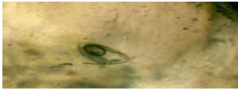
*Рис.2* Одиночное газово-жидкое включение
