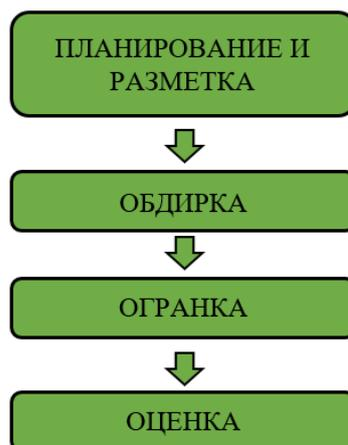
**Рисунок 5.** Последовательность обработки НРНТ алмазов.
