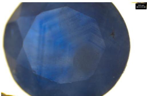
**Рисунок 7.** Нечеткие границы гексагональной зональности; растворенные иглы рутила. Проходящий свет.
