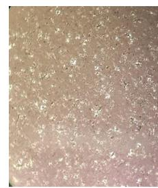
**Рисунок 14.** Шлиф, сделанный из материала бусины сиреневого цвета. Слева проходящий свет, справа – скрещенные николи. Поле зрения 1,7 мм
