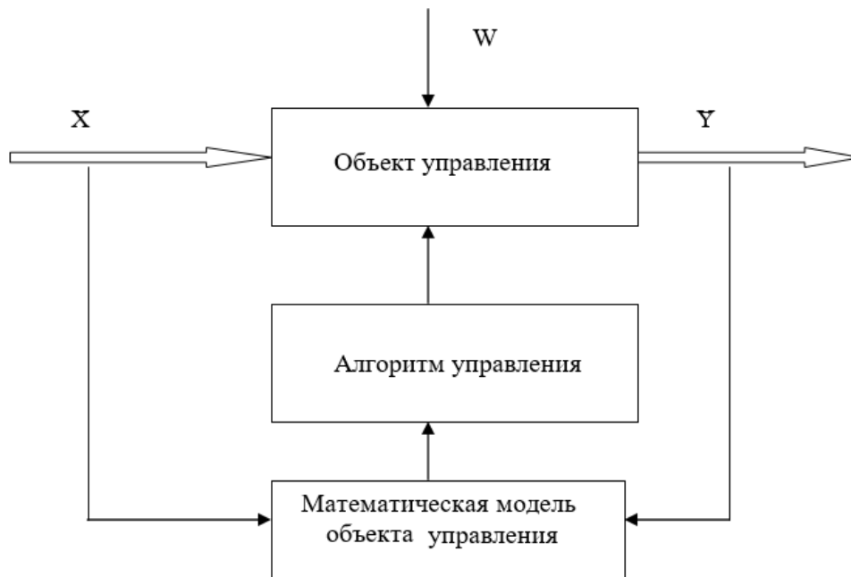
Рис. 1. Функциональная схема системы управления сложным объектом
