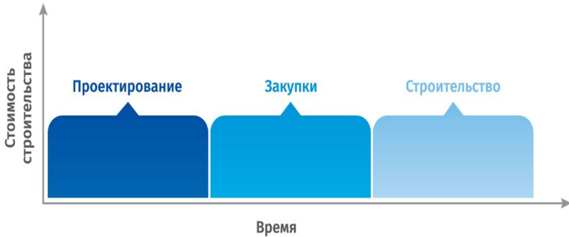
Рисунок 1. Классическая схема последовательности выполнения работ при строительстве объекта.
