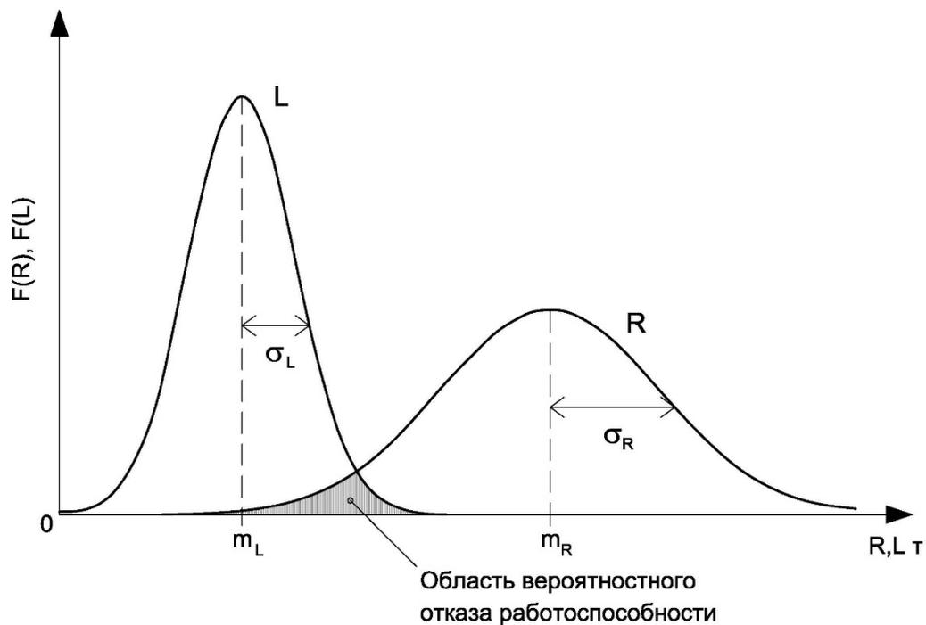
Рис. 3.11. Графическая интерпретация отказа работоспособности системы
