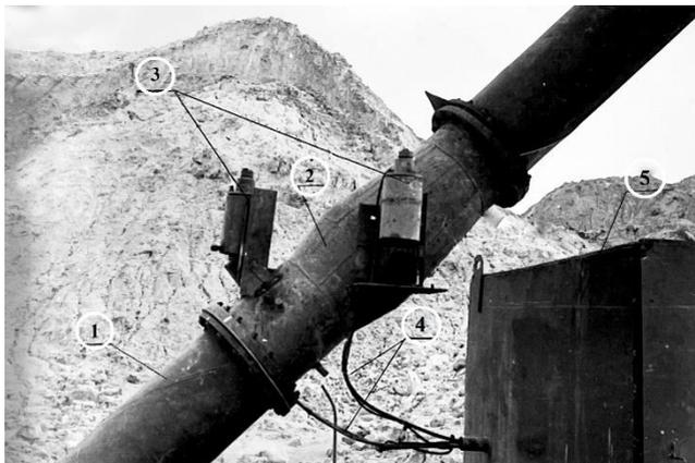
*Рис. 6. Гидродинамический расходомер с расширяющим устройством (диффузором) («труба Антивентури») при гидротранспорте пород на карьере Иршинского ГОКа. 1 – нульповод, 2 – расширяющее устройство (диффузор); 3 – разделители с эластичными диафрагмами; 4 – импульсные трубки; 5 – шкаф для первичного датчика и вторичного регистрирующего прибора.*
