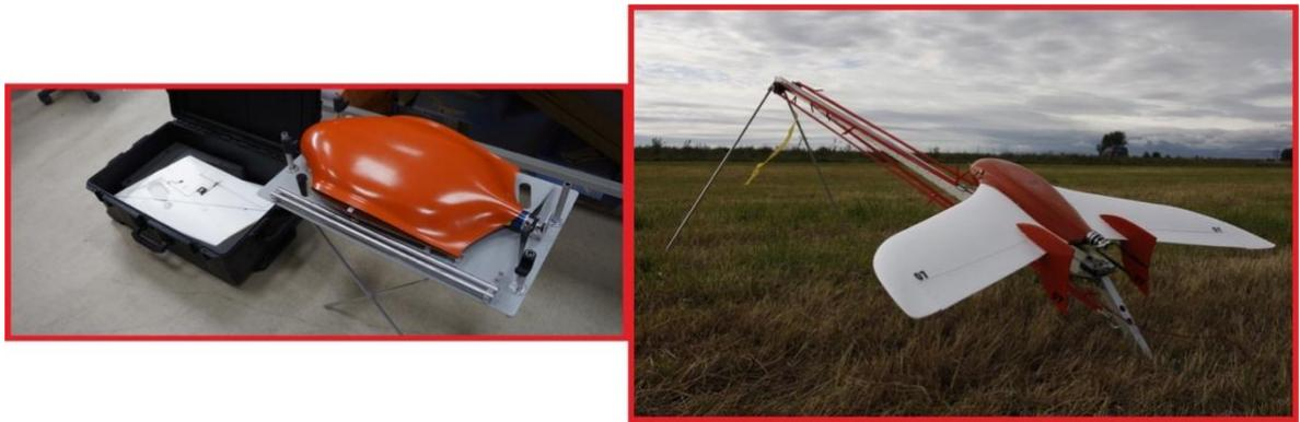
Рис. 47. Беспилотный летательный аппарат Геоскан-201
