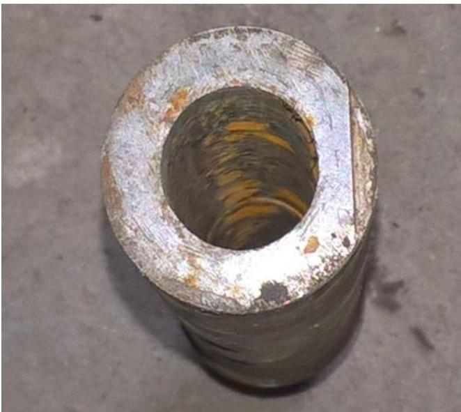
**Рис. 2.6.** Модифицированный ударник для нанесения внецентренного ударного импульса
