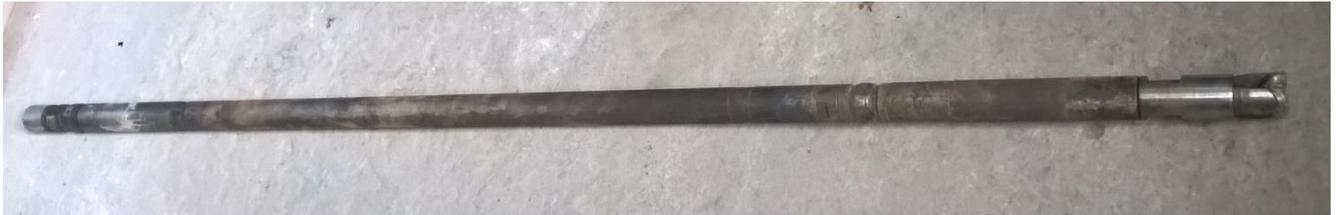
**Рис. 2.5** Забойная компоновка для проведения эмпирических исследований
