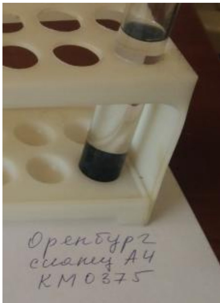
Рисунок 3.3 – Результат экстракции хлороформенного битумоида из углеродистых сланцев Кумакского рудного поля.
