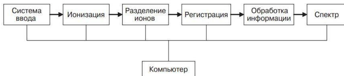
Рис. 2.4. Блок-схема работы масс-спектрометра
