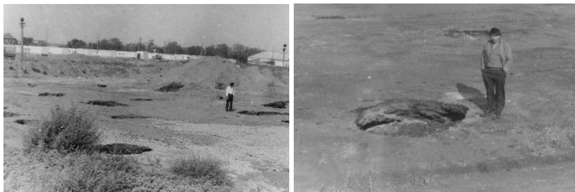
Рисунок 4.4 – Провалы после камуфлетных взрывов в сухих лёссах.
