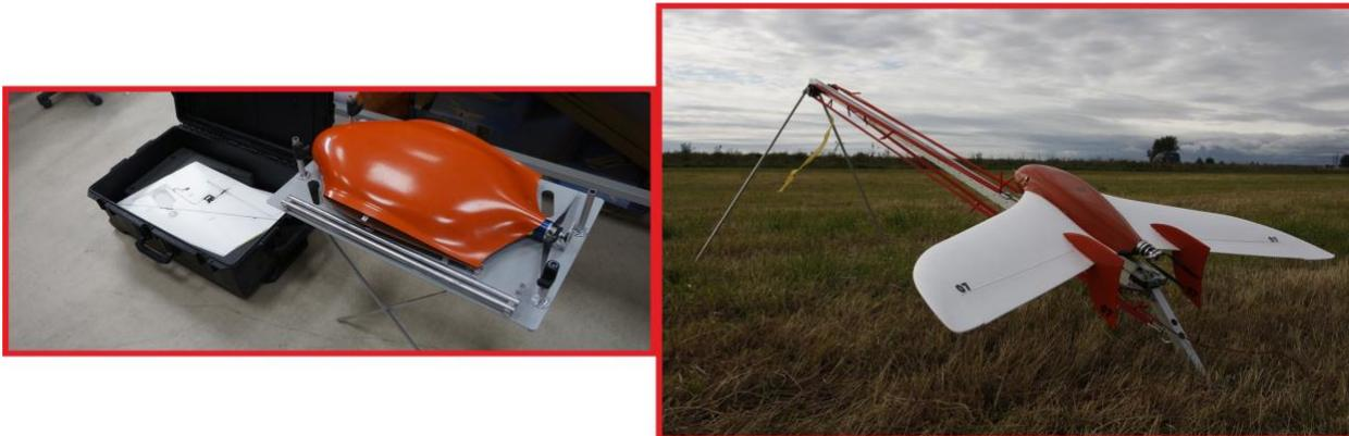
Рис. 8. Беспилотный летательный аппарат Геоскан-201
