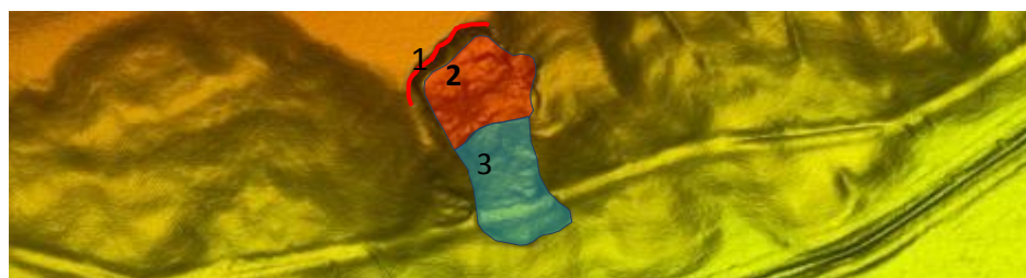
Рисунок 4. Оползень с первичными составляющими «геоморфологического образа», плотность ТЛО 5-9 точек на мк.в. 1 – бровка срыва; 2 – голова оползня; 3 – подошва оползня.
