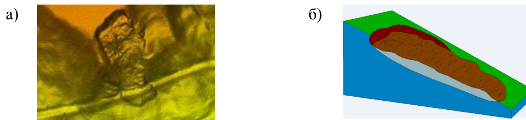
Рисунок 5. Сравнение «геоморфологического образа» оползня с типизированной моделью. а) – цифровая модель рельефа с определенным видом «образа» геологического процесса; б) – типизированная модель оползня вязко-пластичного течения отражающая элементарные примитивы присущие только этому явлению.
