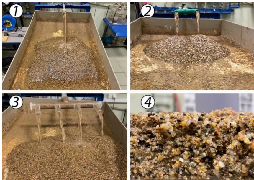
Рис. 13. Намыв массива загрузочным аппаратом торцевым и рассредоточенным выпуском гидросмеси. 1 – торцевой выпуск, S=15\% ; 2 – два патрубка S=35\% ; 3 – четыре патрубка S=15\% ; 4 – структура разрыхленного массива при формировании штабеля рассредоточенным выпуском.
