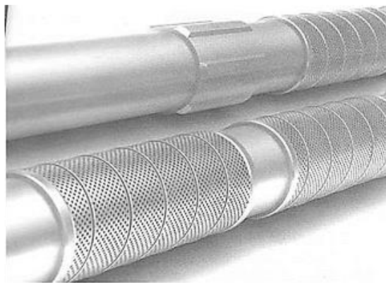
Рис. 1.10. Витой кожух фильтра с применением механического замка, перфорированный круглыми отверстиями диаметром 5 мм
