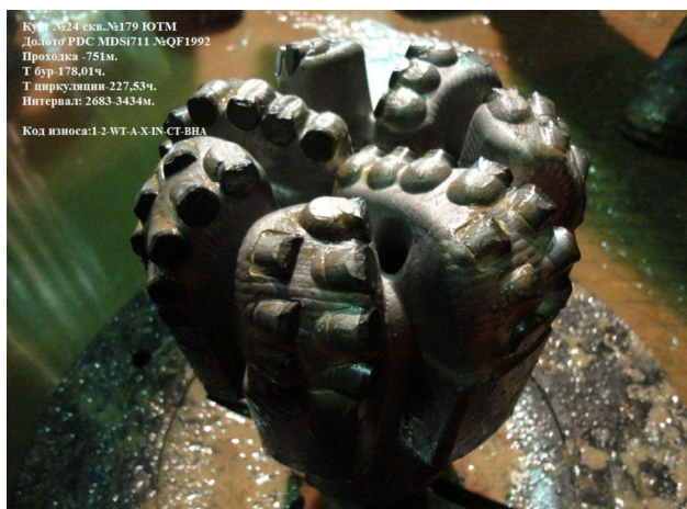
Рис. 3.5. Долото PDC после проходки 751 м (время бурения 178 ч), интервал проходки 2683–3434 м, скважина №179, куст №24, Юрубчено-Тахомского месторождения (Россия, Восточная Сибирь)
