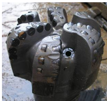
Рис. 3.6. Долото PDC Tornado после проходки 1150 м
