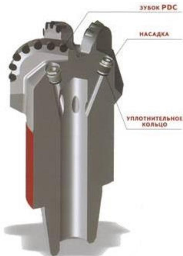
Рис. 1.1. Буровое долото, армированное пластинами PDC
