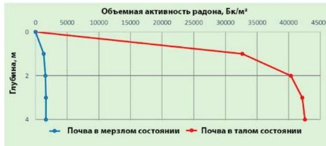
Рисунок 4.8 – Диффузия радона в условиях мерзлой и оттаявшей породы
