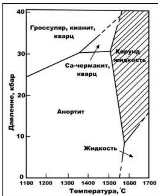
Рисунок 2.1 Поле стабильности анортита, корунда и других минералов при высоких давлениях и температурах [ Hughes, 1997]
