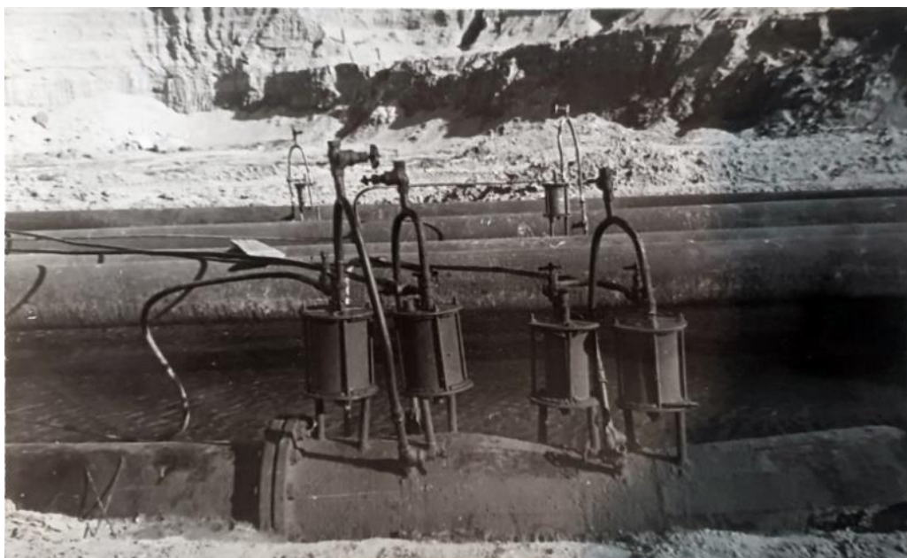
Рис. 3.4. Труба Вентури с разделителями.
