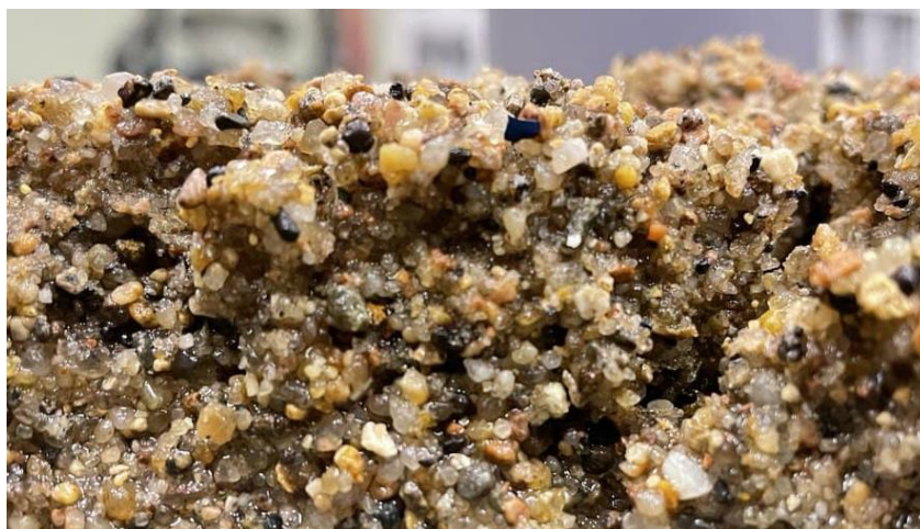
Рис. 3.13. Рыхлая структура намытого массива при опытных исследованиях рассредоточенным выпуском.
