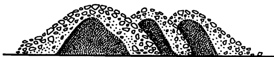
Рис. 1.10. Сегрегация частиц при формировании штабеля.
