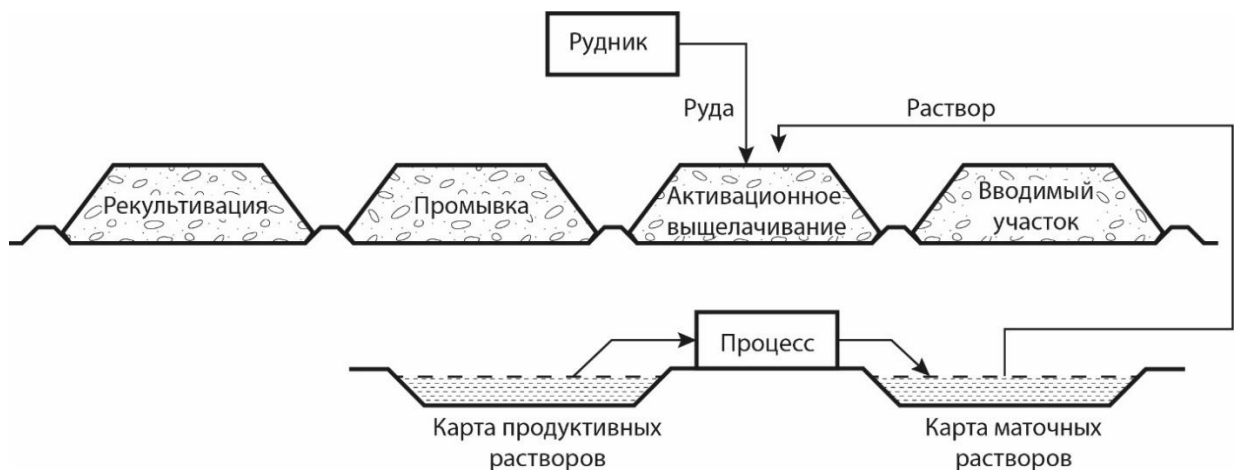
Рис. 1.4. Схема кучного выщелачивания руды на постоянно используемых площадях [97].
