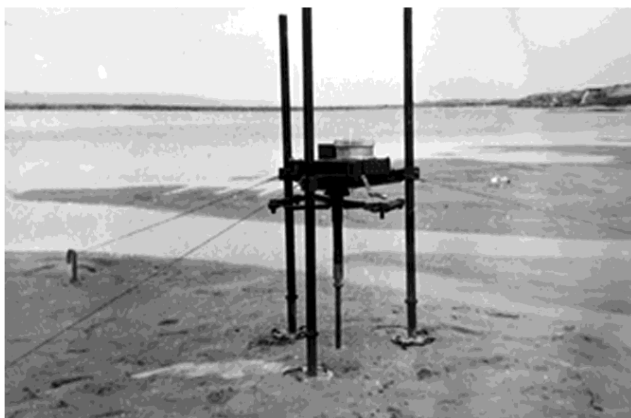
Рис. 3.6. Определение сопротивления сдвигу намытых пород на отвале №1 лопастным прибором «Крыльчатка»
