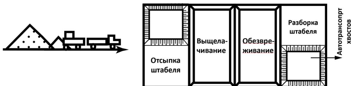
Рис. 1.9. Формирование штабеля по традиционной схеме (методом отсыпки)
