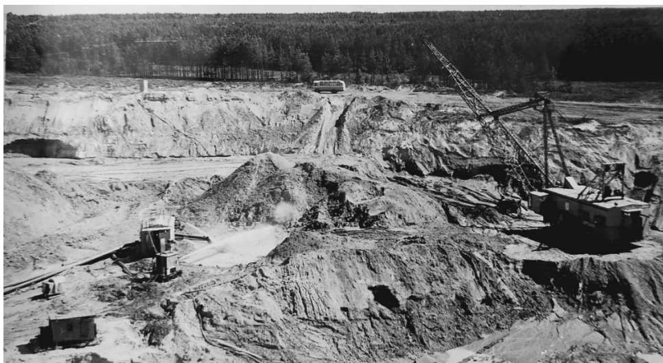
Рис.1.1. Экскаваторно-гидравлическая разработка террасовой россыпи на ИГОКе.
