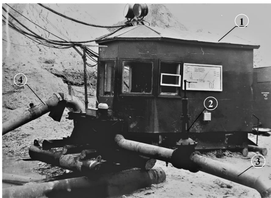
Рис. 5.5 б. Общий вид кабины гидромониторщика. 1 – кабина; 2 – задвижка; 3 – водовод; 4 – гидромонитор ГМД-250.
