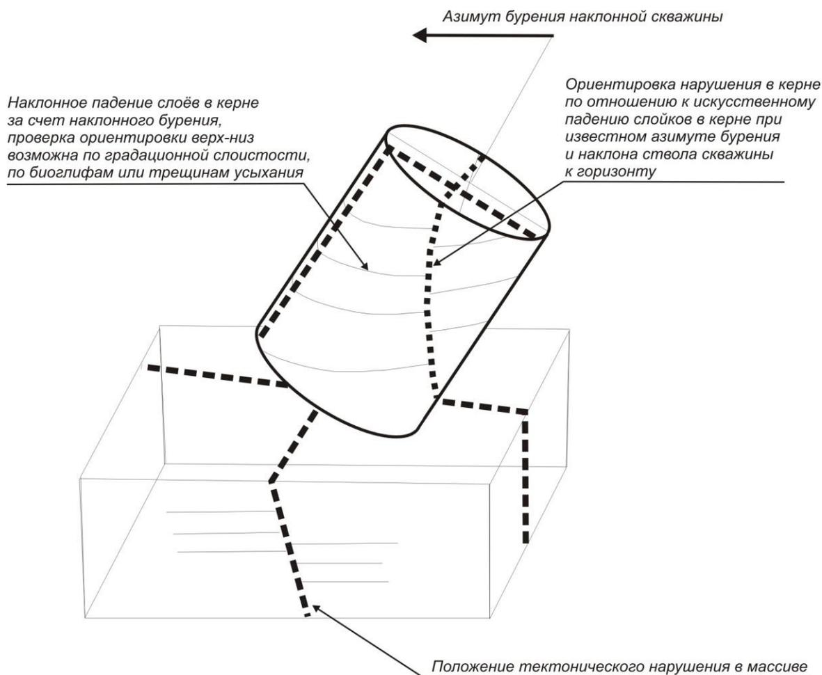
Рис. Схема получения ориентированного керна для определения положения в пространстве признаков тектонических нарушений по керну и отбора ориентированных образцов для проведения ультразвуковых исследований по методике В.И Старостина
