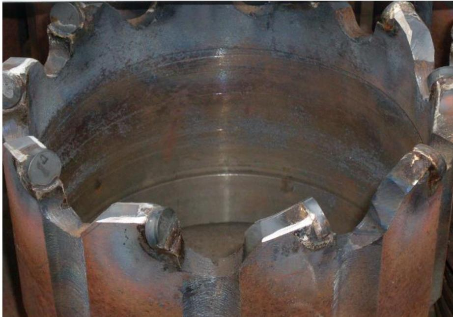
Рисунок 4.8. Коронка, армированная АТП, после обработки в жидком азоте
