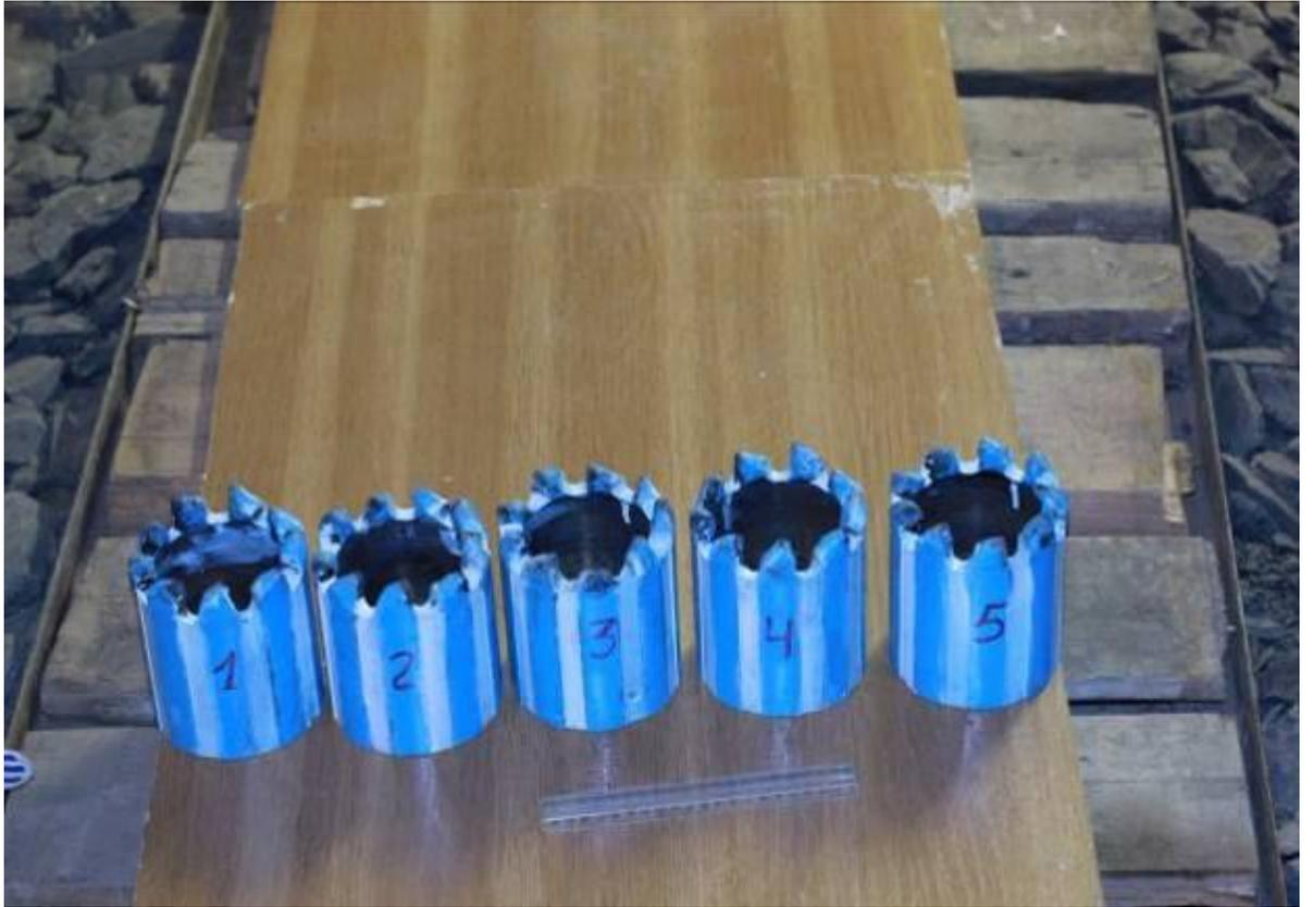
Рисунок 3.5 Коронки типа PQ, армированные АТП
