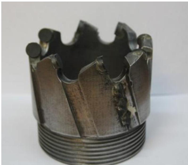
Рисунок 3.11. Стабилизирующая, антивибрационная буровая коронка
