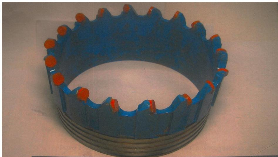
Рисунок 1.6 – Коронка диаметром 225 мм, армированная АТП
