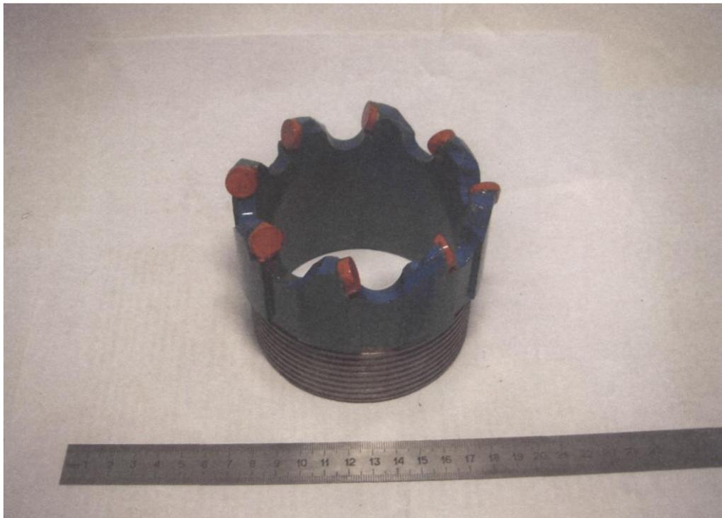
Рисунок 1.5 – Коронка диаметром 112 мм, армированная АТП
