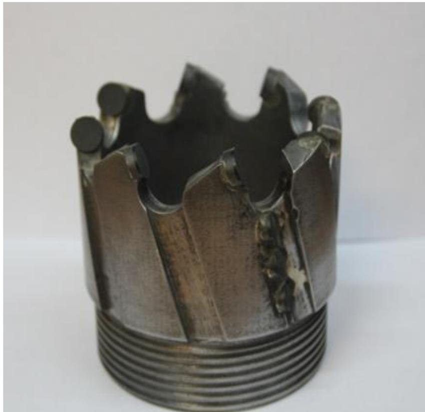
Рисунок 2.11 Коронка удлиненная, стабилизирующая, антивибрационная
