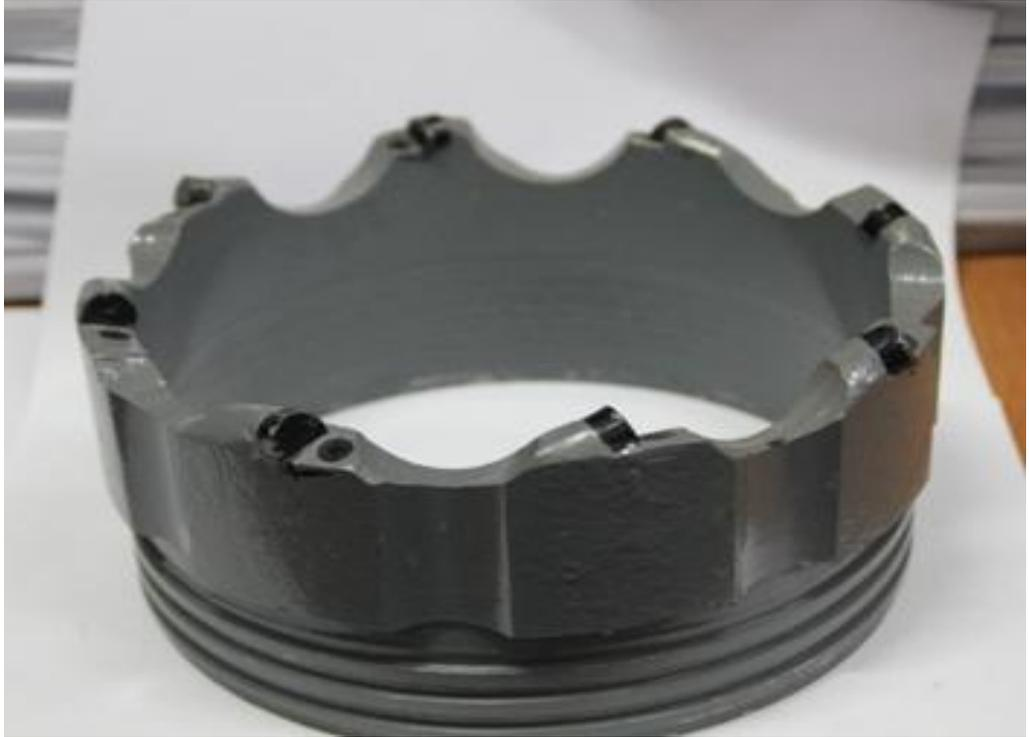
Рисунок 3.20 Буровая коронка с механическим креплением АТП
