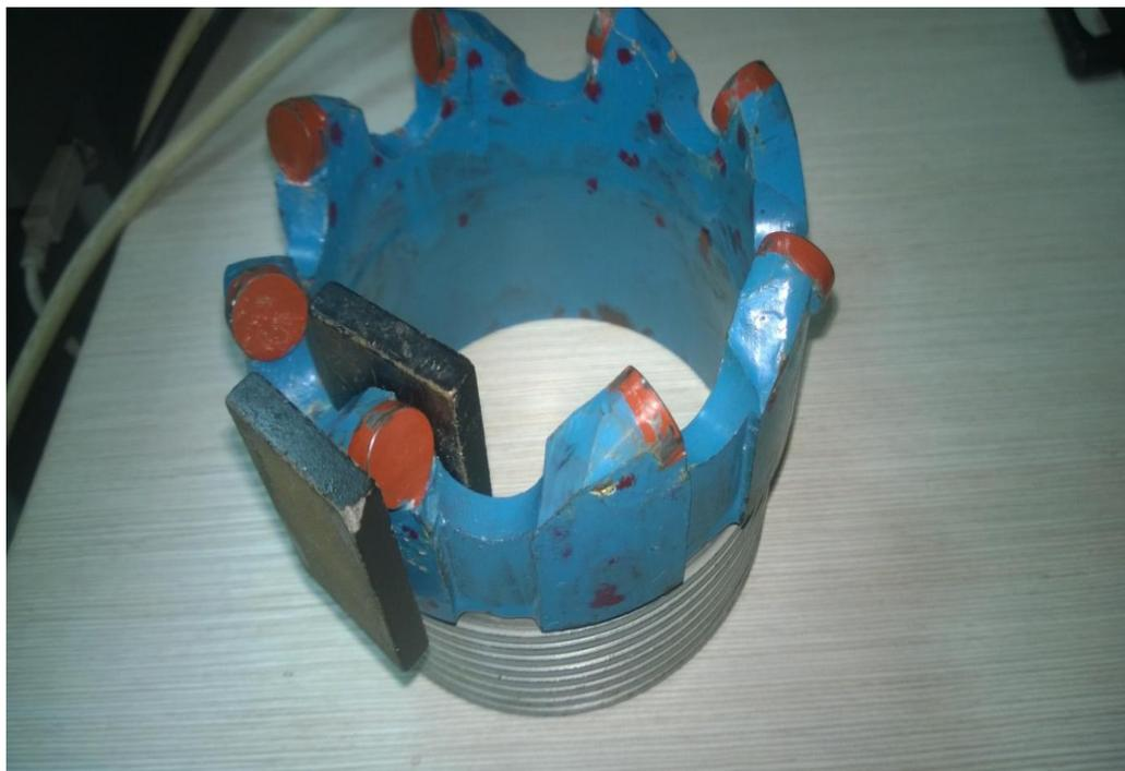
Рисунок 4.19 Намагничивание и размагничивание коронки в лабораторных условиях
