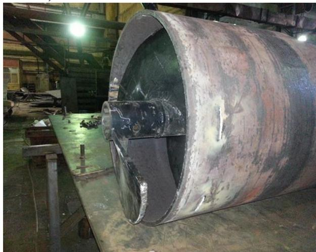
*Рис.14. Шнеко-аккумулирующий буровой снаряд Ø750 мм.*
