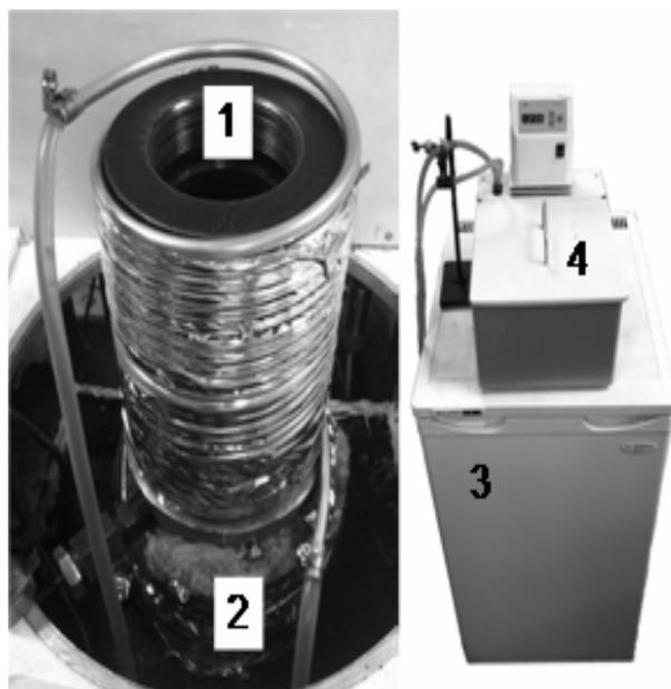
Рис. 2. Новая система охлаждения, 1 – рабочая камера с медной охлаждающей рубашкой, 2 – теплоизоляционный кофр, 3 – морозильная камера, 4 – термостат.
