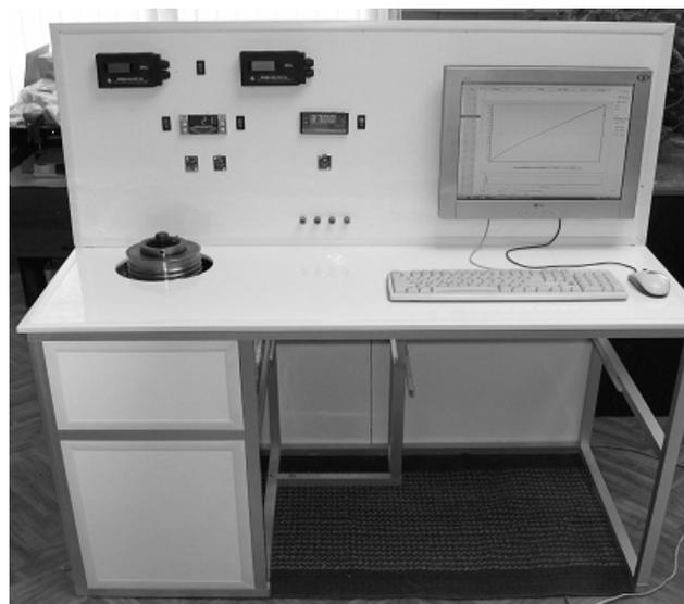
Рис. 6. Общий вид установки для измерений тепловых свойств консолидированных горных пород и руд при совместном влиянии повышенных температуры, всестороннего и порового давлений.
