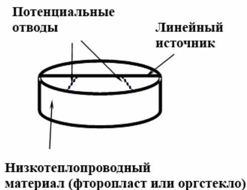
Рис. 9. Схема накладного датчика для измерений тепловых свойств рыхлых пород.
