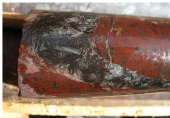
Рис. 4. Прожилок карбонат-гематит-кварцевого состава с урановой минерализацией в толще вулканитов. Участок Безымянный, скважина №99, гл. 290,9 м. Материалы автора, 2009 г.
