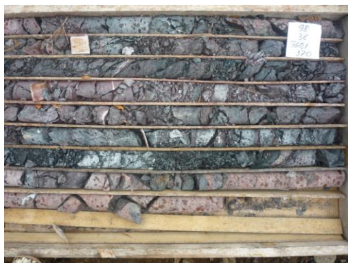
Рис. 3. Зоны дробления в вулканитах хибеленской свиты, обогащенные рудной минерализацией. Участок Безымянный, скважина №98, инт. 360,1-370,0 м. Материалы автора, 2009 г.
