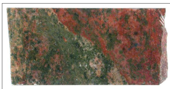
Рис. 8. Гнездово-вкрапленная текстура распределения браннерита в вулканитах. Участок Дорожный (рудопроявление Мотылёк). Скважина 236, интервал (75,15 м-76,15 м). Материал автора. а) Фото образца. Размер 3,5 x 8,0 см. б). Радиография. Экспозиция 21 сутки. Стустки и точечная вкрапленность браннерита – черные пятна на радиографии.
