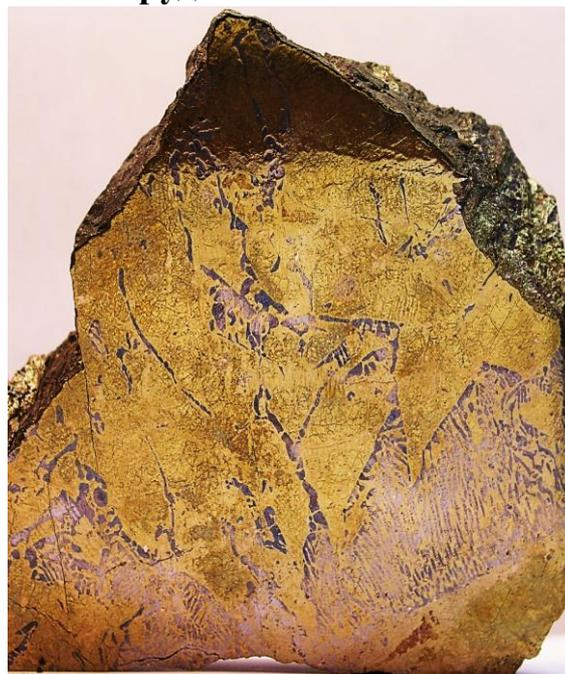
Фото 2. Кубанитовый тип – халькопирит кубанитовая минерализация (видна структура распада кубанита)
