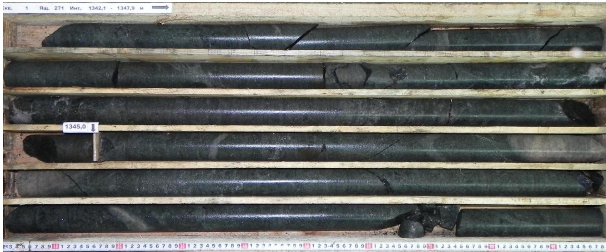
Рис. 14. Пример прослоя зеленоватых амфиболитов в разрезе контрольно-стволовой скважины 1, интервал 1342,1 – 1347,9 м
