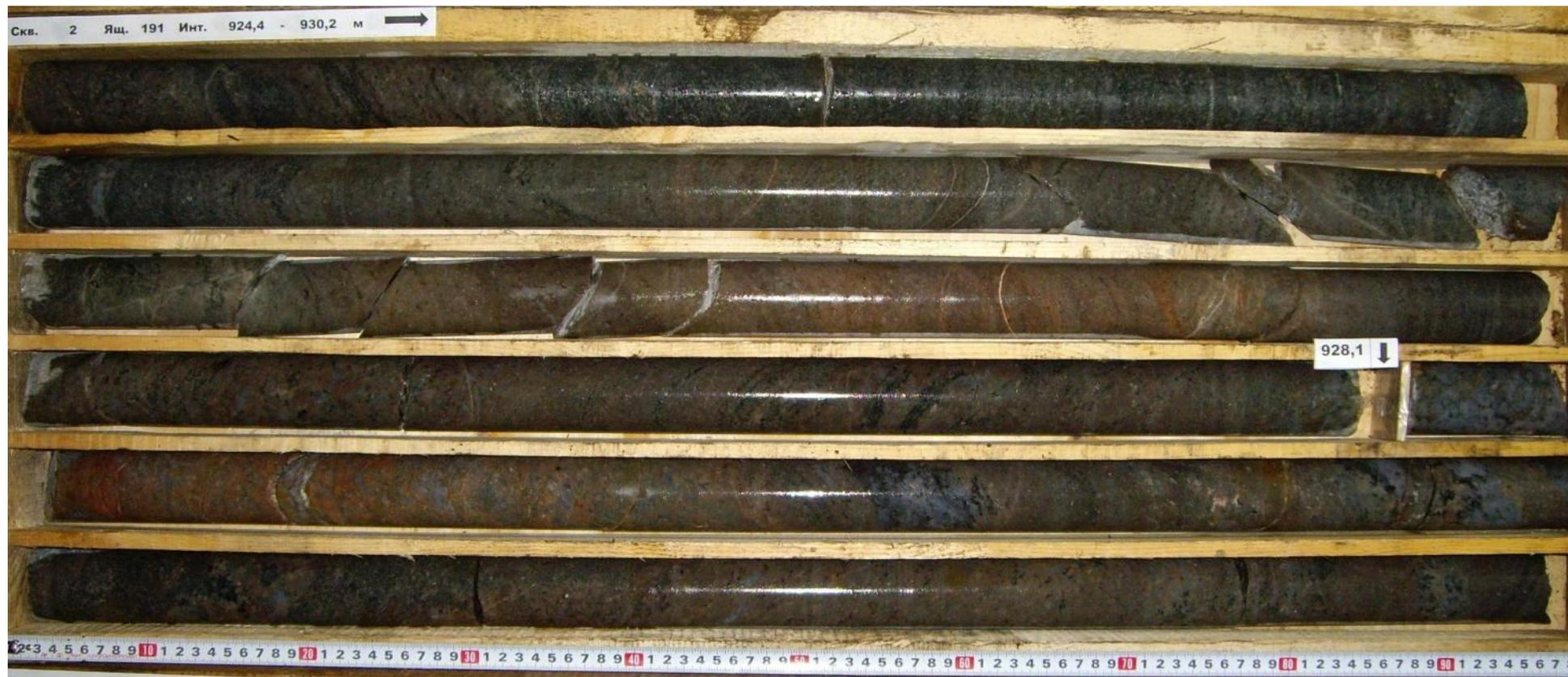
Рис. 22. Прослой плагиогранитов чарнокит-мигматитового комплекса. КСС-2, инт. 924,4 – 930,2.
