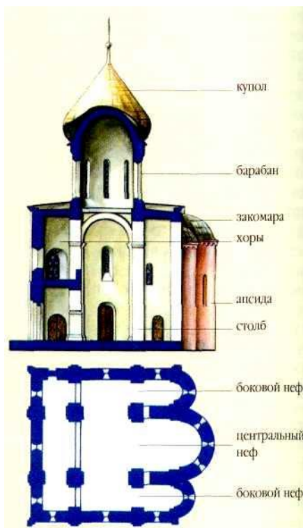
Рис.2. Схема четырехстолпного трехнефного крестово-купольного храма
