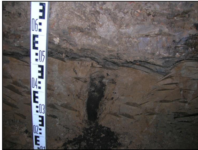
Рис. 28. Свайный стакан, заполненный черной трухой в шурфе 12/05
