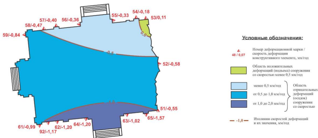
Рис. 18. Схема деформаций конструктивных элементов Успенского собора в период с 1996 по 2010 гг. (до закрепления основания)
