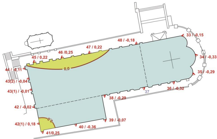
Рис. 94. Схема деформаций конструктивных элементов Трапезного Храма в установившийся период после закрепления основания
