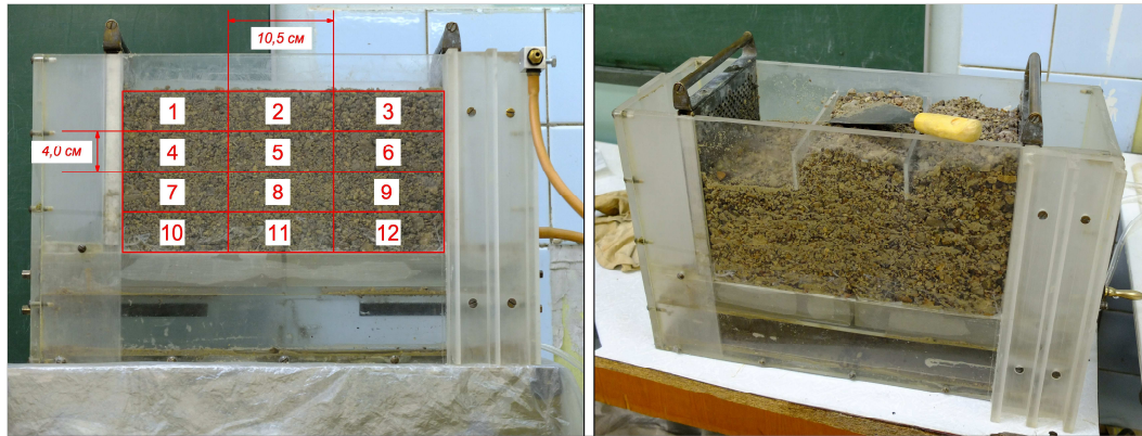
Рисунок 2.18. Схема отбора образцов материала модели из рабочей камеры экспериментальной установки после проведения опыта (слева) и используемые для этого инструменты (справа)
