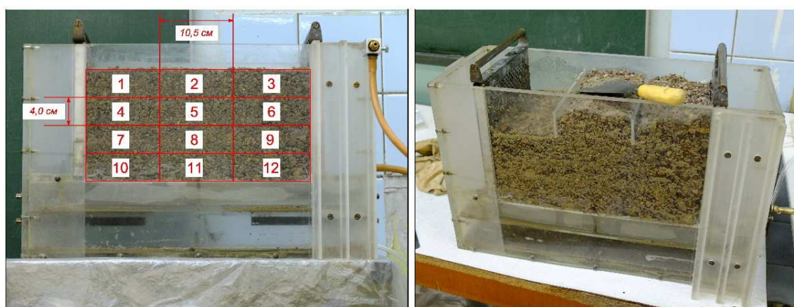
Рисунок 4. Схема отбора проб материала модели из рабочей камеры экспериментальной установки после проведения опыта (слева) и используемые для этого инструменты (справа)
