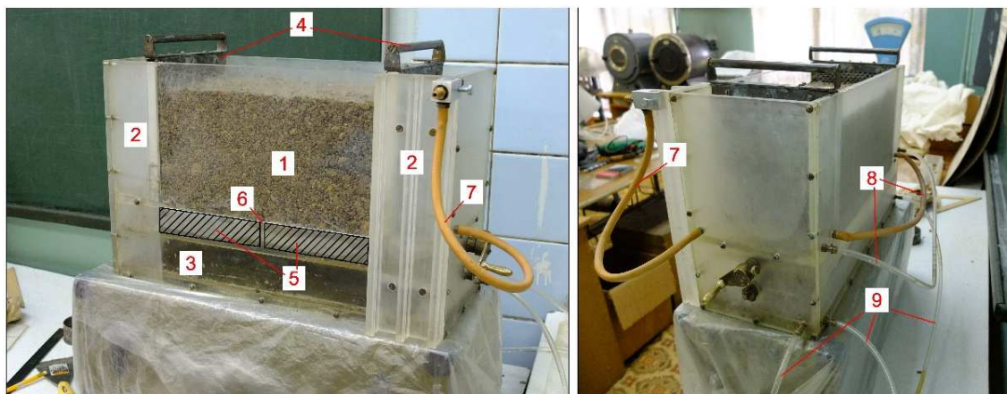
Рисунок 3. Экспериментальное оборудование для моделирования суффозионного выноса частиц несвязных пород в полость
