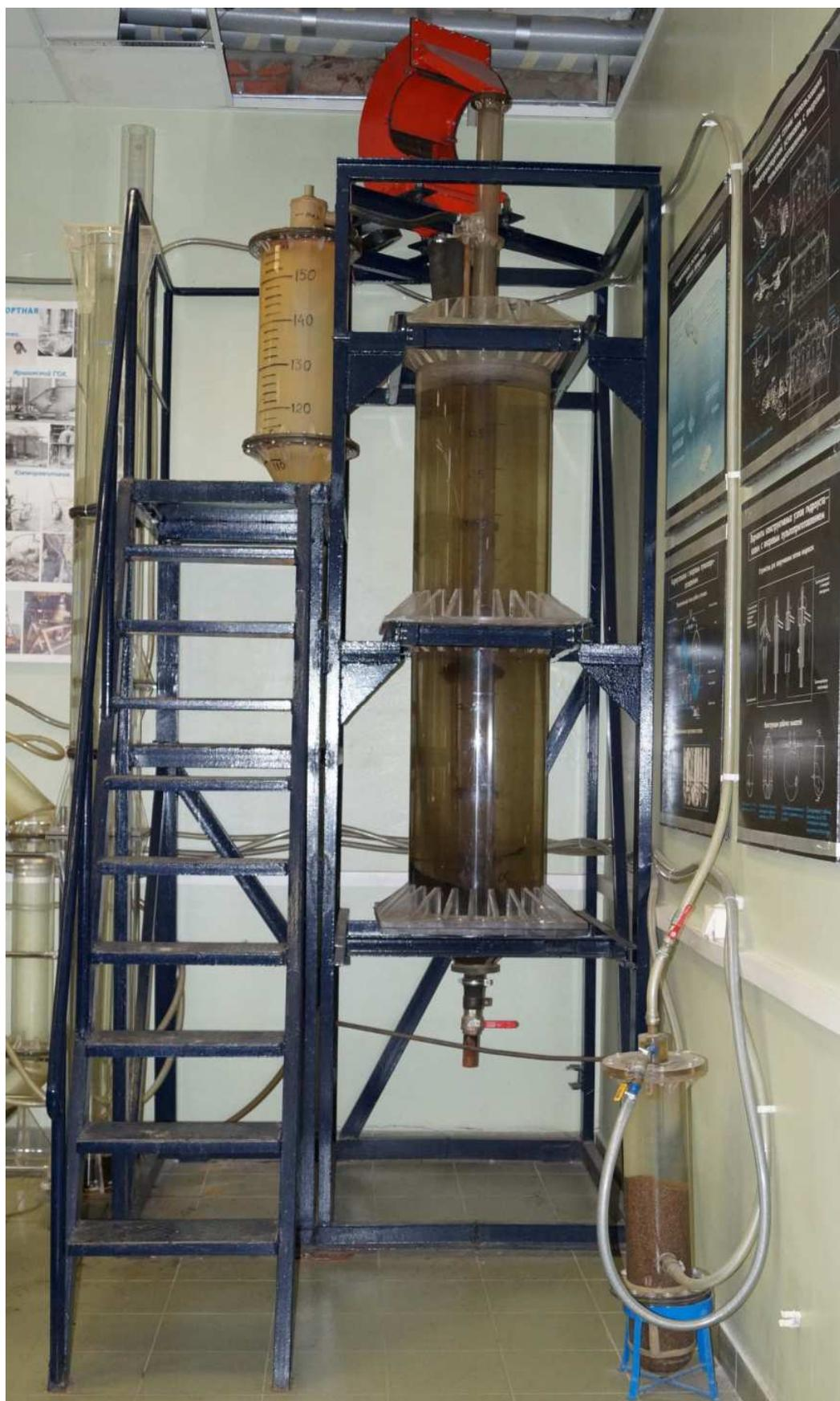
*Рис. 3.4. Лабораторный стенд для проведения испытаний (эрлифтная установка).*
