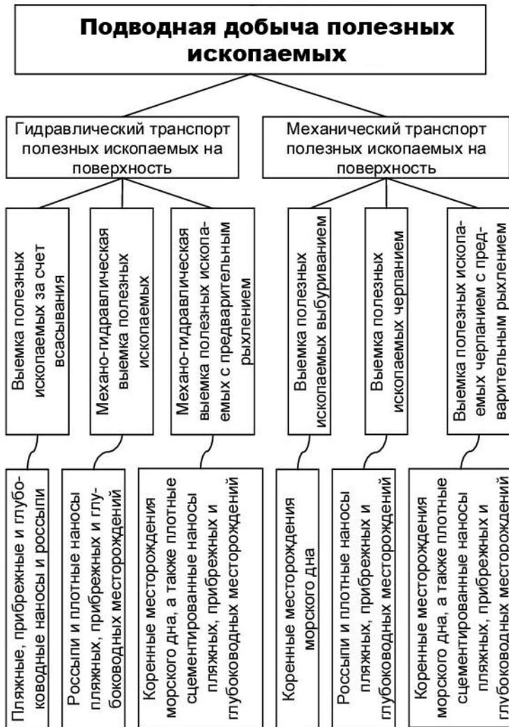
Рис. 1.4. Структурная схема подводной добычи полезных ископаемых.
