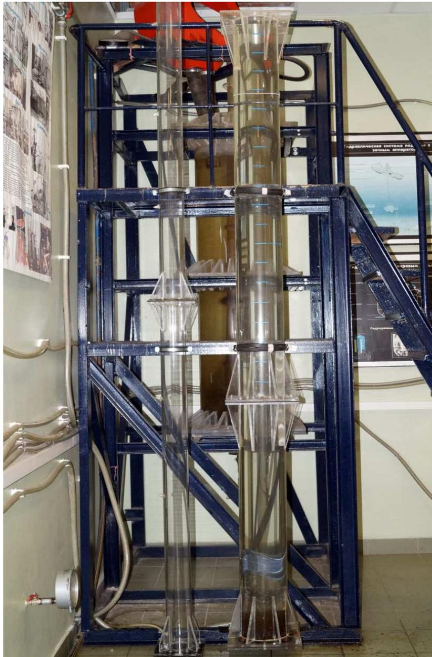
*Рис. 2.7. Лабораторный стенд для определения гидравлической крупности ЖМК.*
