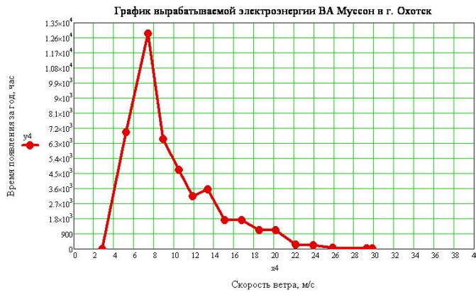
Рис.7. График годовой выработки электроэнергии, ВА Муссон (мощность 30кВт) для г. Охотск.
