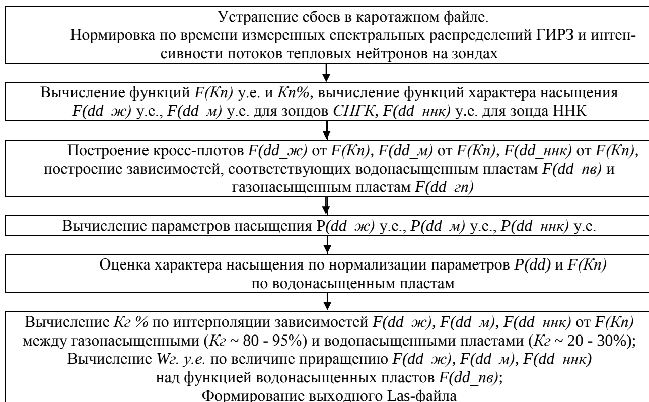
Рис. 5.1 Алгоритм обработки комплекса разноглубинных методов СНГК и ННК и вычисления коэффициента газонасыщенности Kг и объемной газонасыщенности Wг
