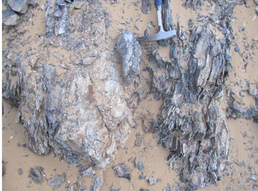
**Рис. 3.7. Брекчированные и полосчатые структуры жильного кварца (карьер по жиле № 9).**
