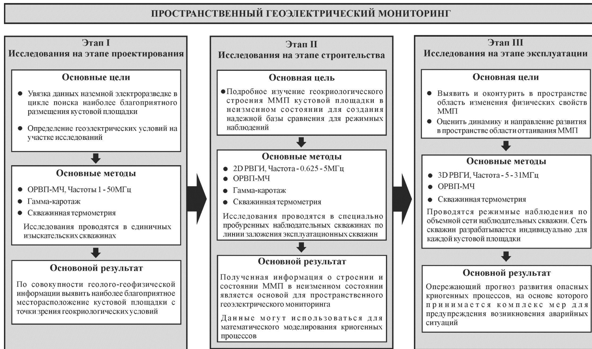
Рис. 48. Основные этапы пространственного геоэлектрического мониторинга скважинными методами
