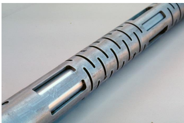
Рис. 1.8. Щели в стальном корпусе зонда ВАК
