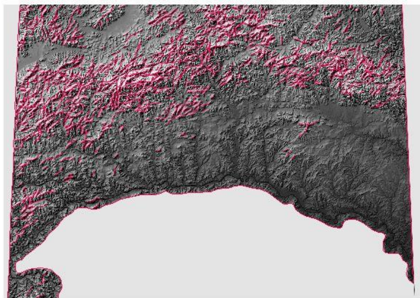
Рисунок 29 Результат работы автоматизированного алгоритма линеаментного анализа процедуры LINE [PCI Geomatica, URL: http://www.pcigeomatics.com ]
