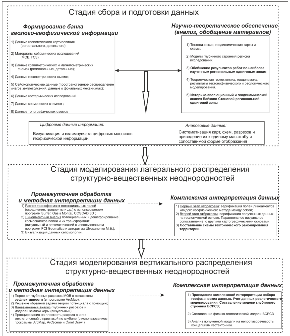
Рисунок 26 Технологическая схема, отражающая последовательность стадий комплексных исследований глубинного строения БСЗ
