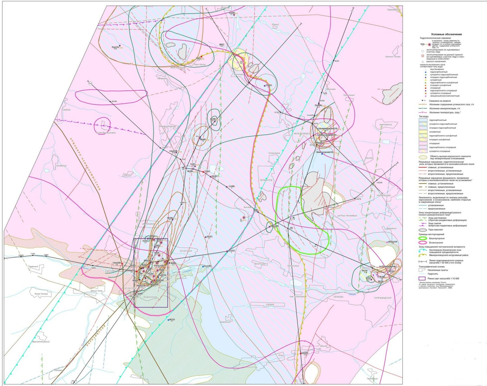
Рис. 1.7 Гидрогеохимическая карта-схема датско-зеландского (эльбурганского) водоносного горизонта
