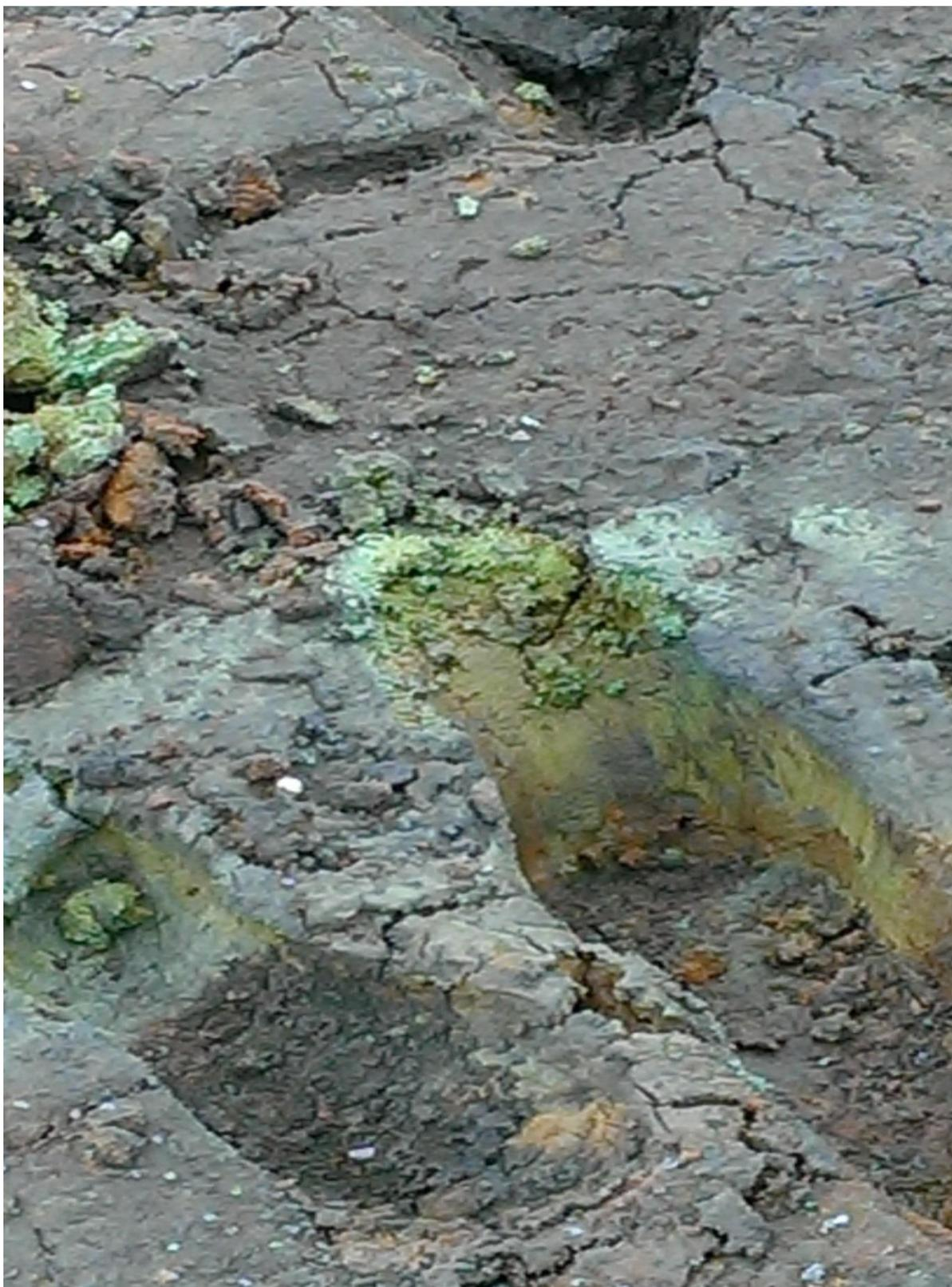
**Рис. 2.8.** Зональность криогенных солей зоны окисления концентрата. Белый цвет – основной сульфат железа, коричневый – гидроксиды Fe, зеленый – основной сульфат Cu, Ni
